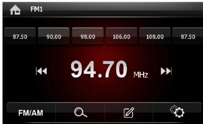
(2) Drehen Sie den Knopf zur manuellen Suche nach rechts/ links. Die manuelle Suche erfolgt in 0,05-MHz-Schritten.
