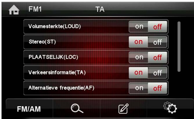
TA (Verkehrsinformationen) ein: Wenn TA eingeschaltet ist, werden sämtliche Verkehrsfunkdurchsagen (z. B. die „beliebten“ Staumeldungen) empfangen: Die reguläre Wiedergabe wird solange unterbrochen, nach Ende der Verkehrsfunkdurchsage wieder fortgesetzt. Das Gerät wechselt anschließend wieder zum zuletzt angezeigten Bildschirm zurück.
