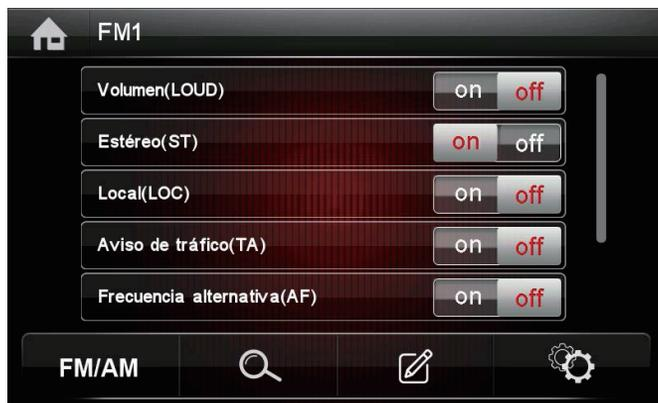
TA (información sobre el tráfico) activado: Cuando la TA esté activada (abierta), si se transmite cualquier anuncio sobre el tráfico, esta función se activa, la radio se para y se da la información al conductor. Después de esto, el dispositivo continúa con la reproducción de la última pantalla.
