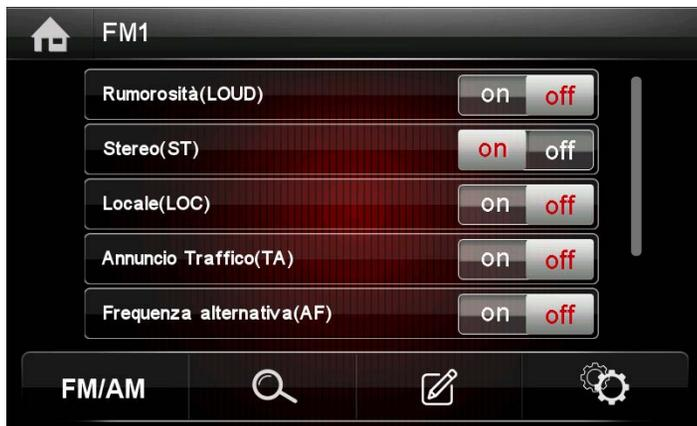
TA (info traffico) ON: Quando TA è attivo (aperto), se viene trasmesso un annuncio sul traffico e poi questa funzione diventa attiva e poi la radio si riavvia e vengono date le info al guidatore. Dopo di ciò il dispositivo continua a riprodurre l'ultima schermata.
